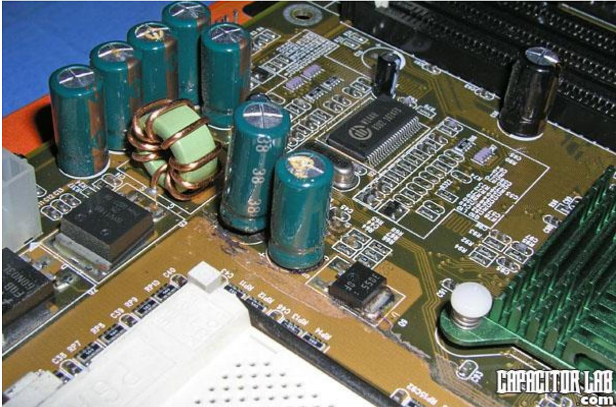
**Gambar 2.20** Contoh kapasitor yang terpasang pada rangkaian elektronik (Capacitor Lab)
