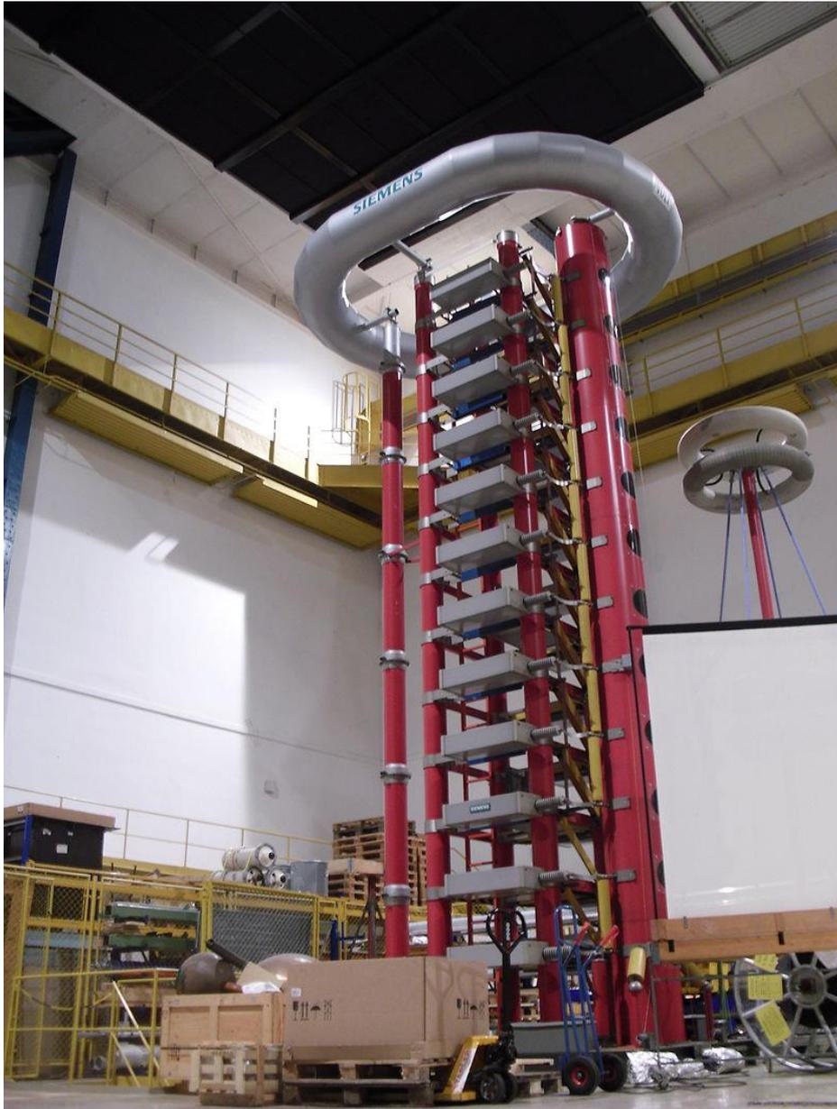
**Gambar 2.47** Pembangkit Marx yang digunakan untuk mengetes komponen transmisi tegangan tinggi yang berada di TU Dresden, Jerman (en.wikipedia.org)
