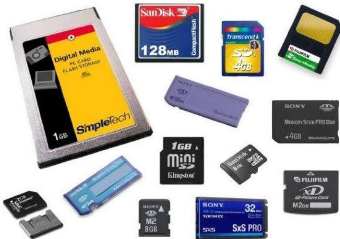
Gambar 1.63 Contoh floating gate memory yang kita jumpai atau gunakan sehari-hari (PC World).
