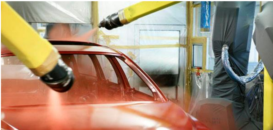
Gambar 1.67 Pengecatan mobil yang baru dibuat dengan teknologi elektrostatik ( http://jf505industrialrobotics.blogspot.co.id/ ).
