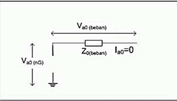
$$V_{nG} = V_{nN} + V_{NG}$$
