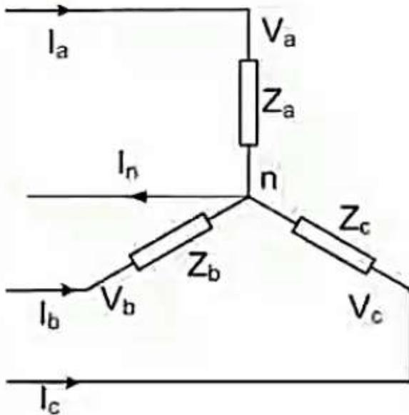
$$\begin{bmatrix} V_a \\ V_b \\ V_c \end{bmatrix} = \begin{bmatrix} Z_a & 0 & 0 \\ 0 & Z_b & 0 \\ 0 & 0 & Z_c \end{bmatrix} \begin{bmatrix} I_a \\ I_b \\ I_c \end{bmatrix}$$
