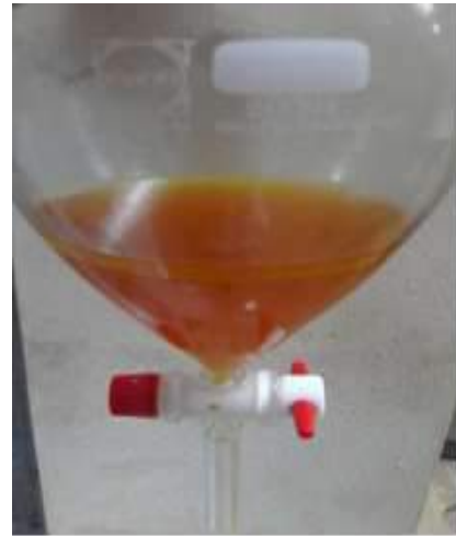
Gambar 4. Hasil transesterifikasi menggunakan katalis \text{Mg}/\gamma\text{-Al}_2\text{O}_3
