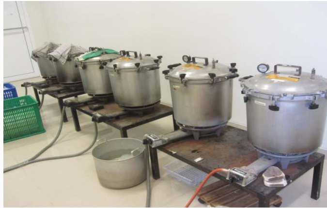
Gambar 3. Autoklaf yang menggunakan daya kompor
