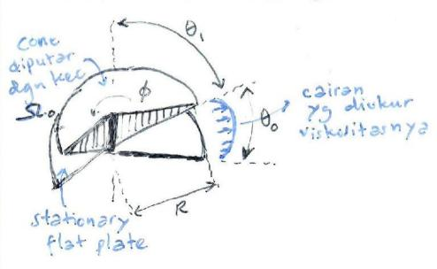
Bo 22 shg B1 ≈ 90° Perhit viskositas berdasarkan pd pengukuran torsi yg diperlukan utti memutar cone dgn sudur tetap = 520
