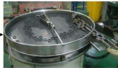
Outer Ring dimasukkan ke sebuah wadah sebelum masuk rel
