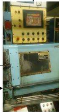
Outer Ring masuk satu per satu ke Mesin SSA 1 untuk proses grinding
