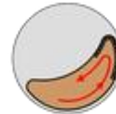
Penggilingan Halus (Kompartmen 2) Cascading grinding media
