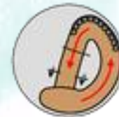
Penggilingan Kasar (Kompartmen 1) Cataracting grinding media
