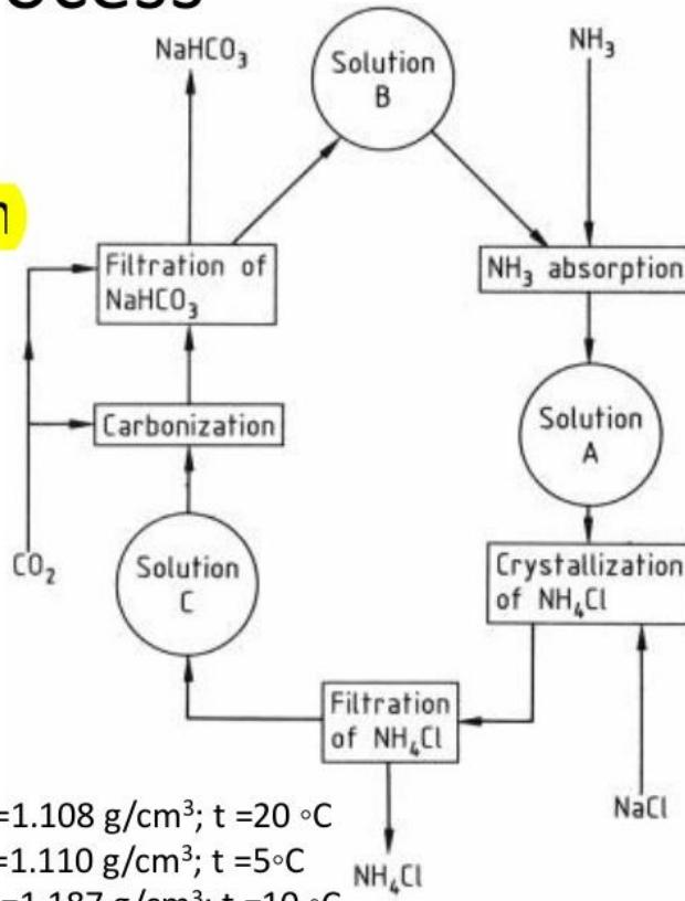
Solution A: 4.1 mol/L  $\text{NH}_4\text{Cl}$  + 1.05 mol/L  $\text{NaCl}$ ;  $\rho=1.108 \text{ g/cm}^3$ ;  $t=20^\circ\text{C}$
