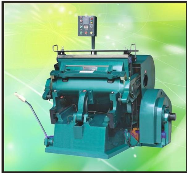
Gambar 6: Mesin cetak foil emas
