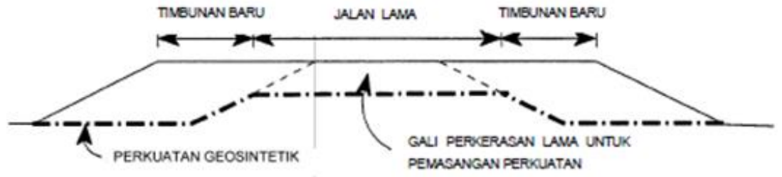
(a) Penimbunan pada kedua sisi timbunan jalan lama
