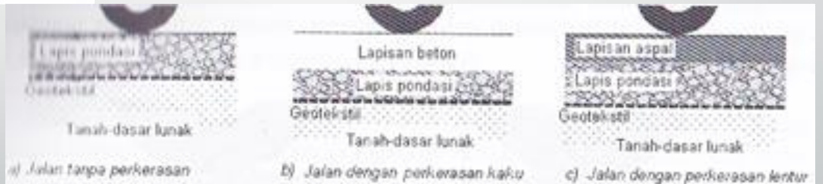
Gambar 2.17 Geotekstil sebagai pemisah antara tanah dasar lunak dan lapis pondasi.
